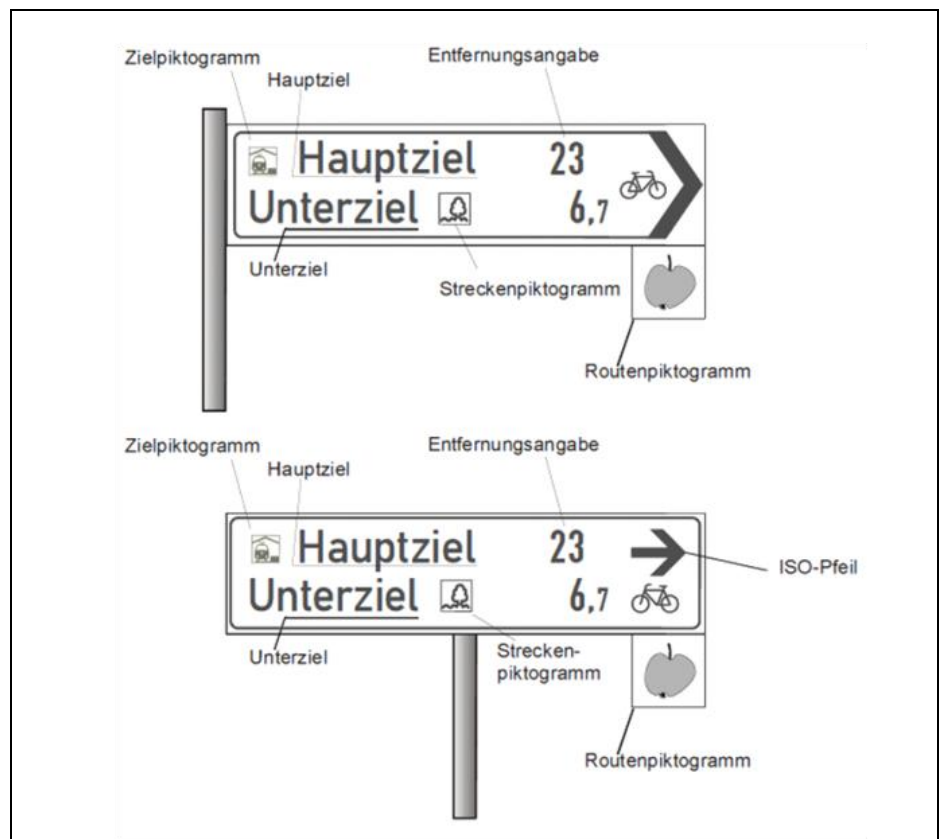
Abb. 8-2: Inhalte der Radverkehrswegweiser Zielwegweiser (FGSV, 2012)
