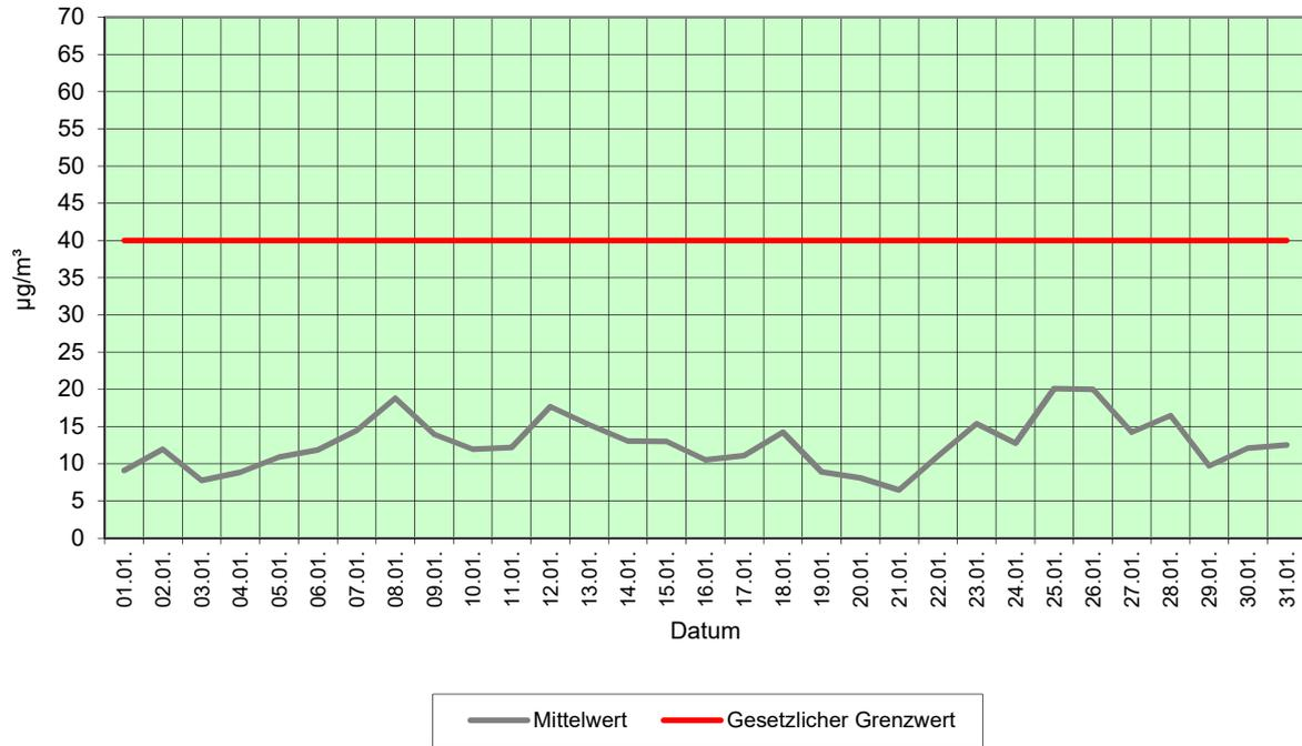
Die Stickstoffoxide sind von großer lufthygienischer Bedeutung. Stickstoffdioxid entsteht prinzipiell als Nebenprodukt bei Verbrennungsvorgängen durch die Oxidation von Luft ( $\text{NO} + \text{O} = \text{NO}_2$ ). Es ist braunrotes, süßlich riechendes Gas und stammt aus den Abgasen von Industrie, Gebäudeheizung und Verkehr.  $\text{NO}_2$  reagiert mit Wasser zu Salpetersäure.
