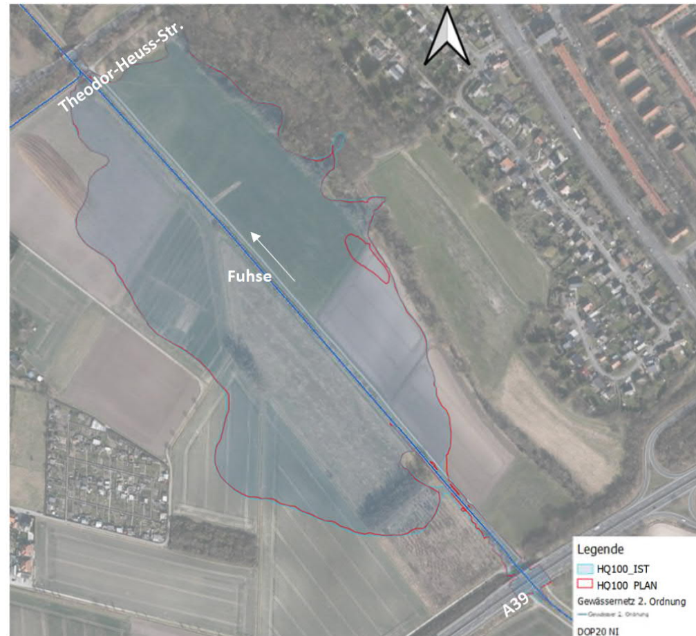
Vergleich HQ100-Überschwemmungsflächen Ist- und Plan-Zustand (Modell)
